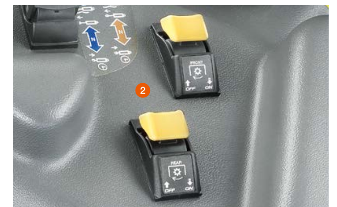
2 Les prises de force avant et arrière s'activent par simple appui sur un bouton.
