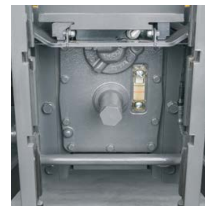
Le niveau d'huile de transmission et d'huile hydraulique peut être contrôlé au moyen du regard à côté de l'embout de prise de force arrière.
