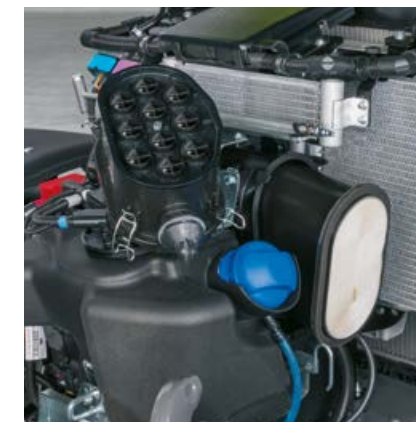
Parfaitement accessible à l'avant sous le capot moteur, le filtre à air PowerCore® permet d'espacer les intervalles de nettoyage.
