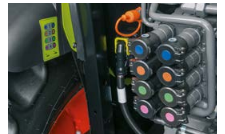
Les coupleurs arrière sont faciles à reconnaître avec leurs codes couleurs et l'autocollant installé à proximité.
