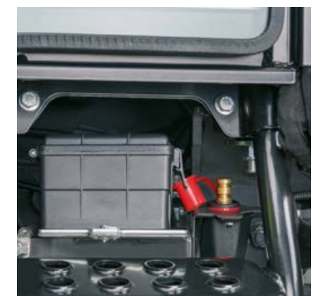
L'AXOS 200 vous facilite le quotidien avec des solutions intelligentes comme des bornes de batterie externes sur le côté droit de la cabine.
