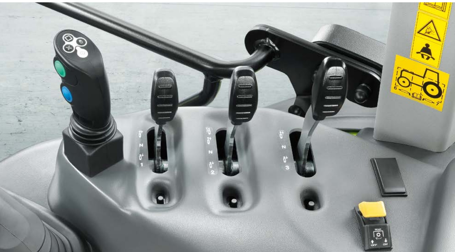
Le débit maximum du distributeur mécanique numéro 3 peut être limité au moyen d'une petite manette en cabine.
