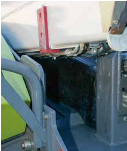
Nach wie vor wird der Telearm im unteren Bereich seitlich abgestützt.
