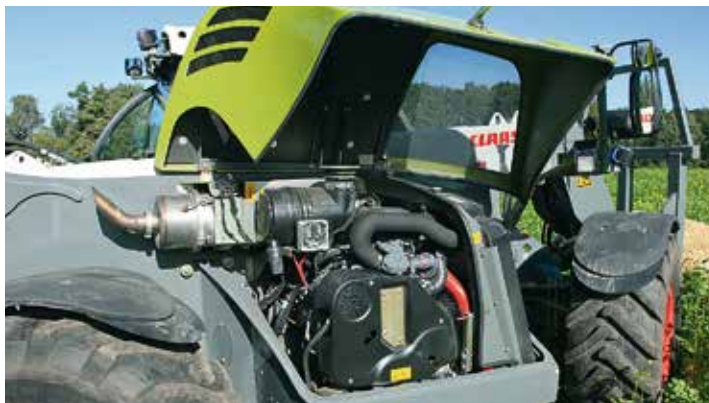
Für den Deutz-Motor im Scorpion 7055 gibt Claas eine Leistung von 115 kW/156 PS an. Der Motor erfüllt mit Oxydationskatalysator (DOC) und Partikelfilter (DPF) die Abgasstufe IIIB (Tier 4 i). Fotos: Eikel
