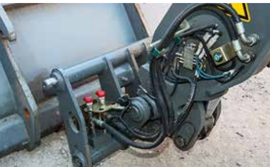
Der Kippzylinder arbeitet jetzt ohne Z-Kinematik. Neu ist der grüne Taster, um den vierten Ölkreis drucklos zu schalten.
