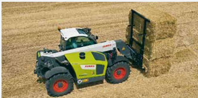
Die kleine Scorpion-Baureihe umfasst drei Teelader mit 6 und 7 m Hubhöhe sowie 3 und 3,5 t Traglast. Foto: Werkbild
