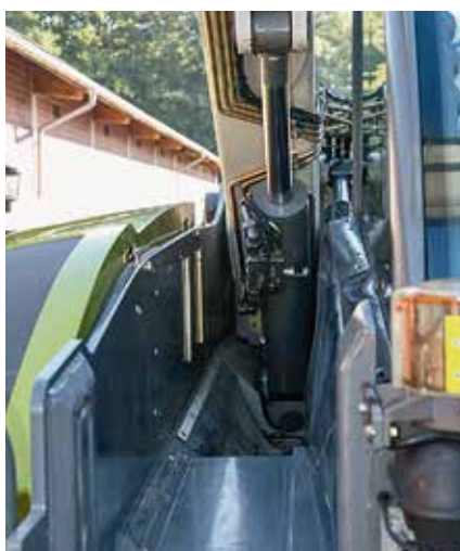
Um die höheren Kräfte aufnehmen zu können, wurde der Rahmen neu konstruiert.
