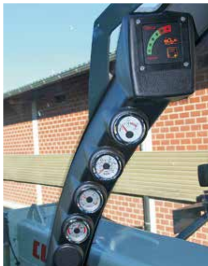
Neben der Überlastanzeige sind weitere Instrumente in die rechte A-Säule gewandert.
