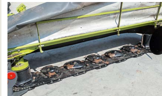
Den MaxCut-Mähbalken hat Claas neu entwickelt, er hat sieben Mähscheiben. Die Verschleißkufen sind einfach tauschbar.
