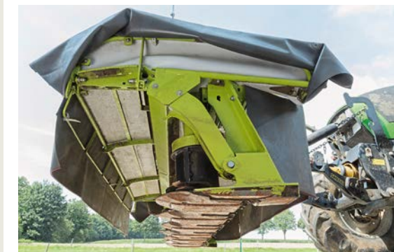
Die Aufhängung des Mähwerks und die Anlenkung des Mähbalkens ermöglichen eine genaue und schnelle Anpassung an die Bodenkonturen.
