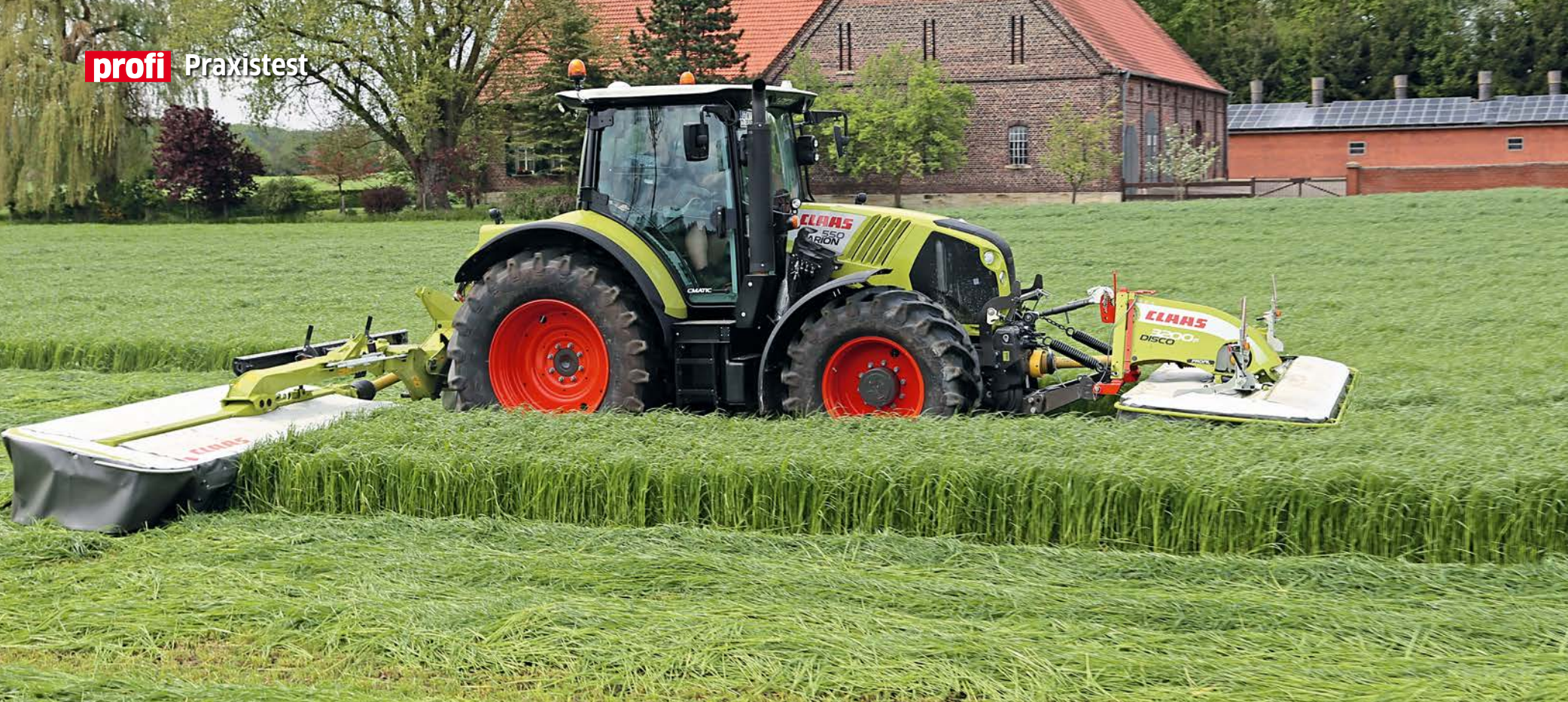
Die Mähkombination hat eine Gesamtarbeitsbreite von 8,10 m und ist einfach zu handhaben. Fotos: Tovornik, Brüse
