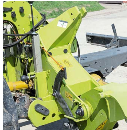
Der Anbaubock ist sehr massiv. Am Test-Gerät gab es nur die Kat. III, als Option ist jetzt auch Kat. II lieferbar. Genial ist das ausgelasserte Stahlteil: Es begrenzt die Aushubhöhe und ist zugleich Transportsicherung.
