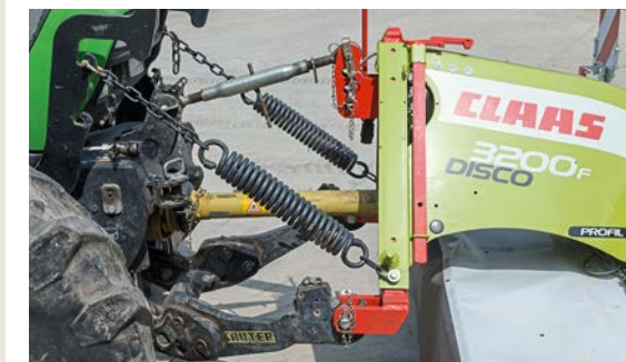
Wie üblich wird über das Weiste-Dreieck gekoppelt. Die mechanische Entlastung hat gut funktioniert.
