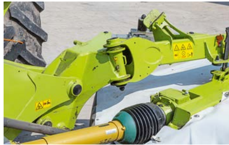
Die Anfahrtsicherung lässt das Mähwerk nach oben und hinten schwenken. Die Vorspannung per Kunststoffblock ist bekannt und bewährt.
