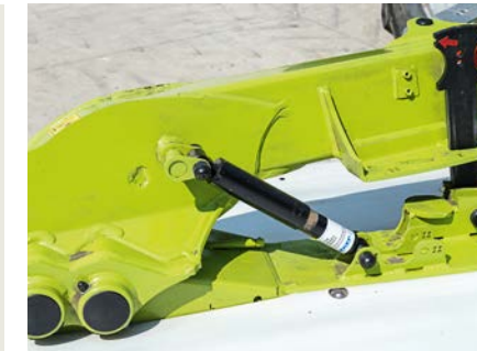
Das Mähwerk kann auch breit mit 8,30 m Schnittbreite gefahren werden. Dazu müssen dann auch Dämpfer und Einstellhilfe umgesteckt werden. Claas hat dazu hilfreiche Markierungen eingelassert. Leider war die Einstellhilfe falsch montiert, der hier zu sehende rote Pfeil müsste vorne sein. An der genialen Hilfe ändert das aber nichts!
