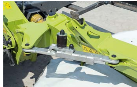
Die Anfahrtsicherung lässt das Mähwerk nach oben und hinten schwenken. Die Vorspannung per Kunststoffblock ist bekannt und bewährt.
