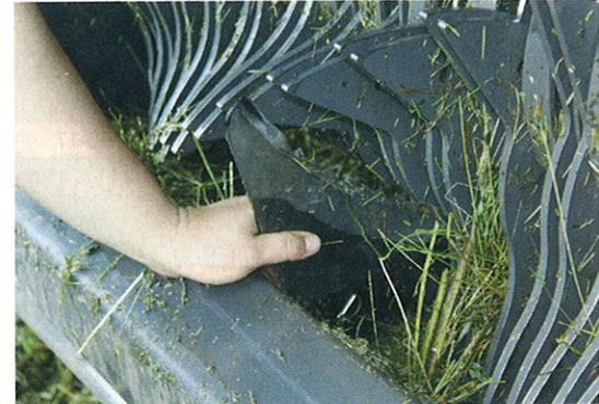
Das Schneidwerk Roto Cut arbeitet mit 14 Messern. Bei Nichtgebrauch ist ein Entnehmen von der Presskammer aus möglich.
