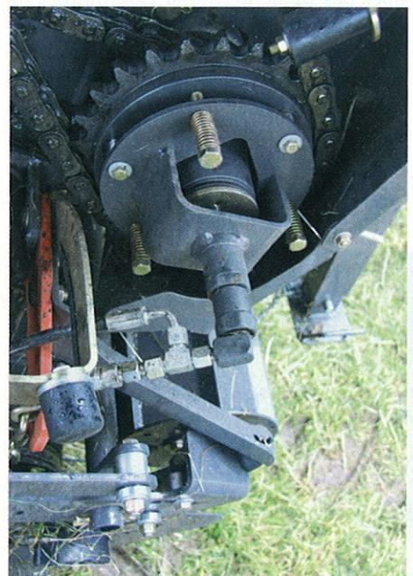
Bei geöffneter Auswurfklappe schaltet die Kupplung den Rotor automatisch ab. Das Netz bleibt beim Auswerfen unbeschädigt.
