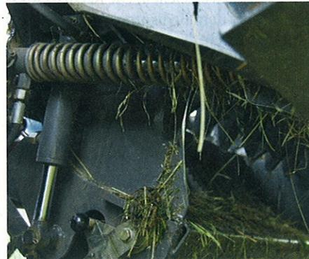
Pressen mit der Bezeichnung Pro können den Schneidwerksboden absenken, um aus der Kabine Verstopfungen zu beheben.
