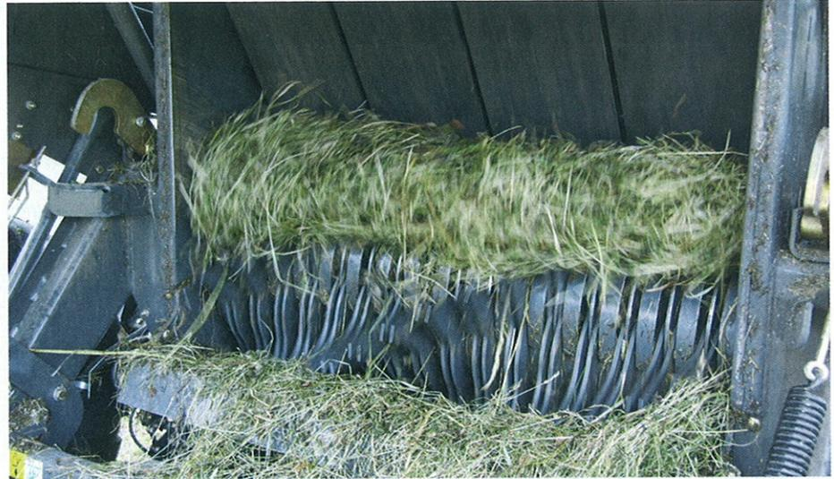
Rotor und Bänder drehen gegenläufig. Dadurch dreht der Ballen von Anfang an und der Ballenkern ist fest gepresst.
