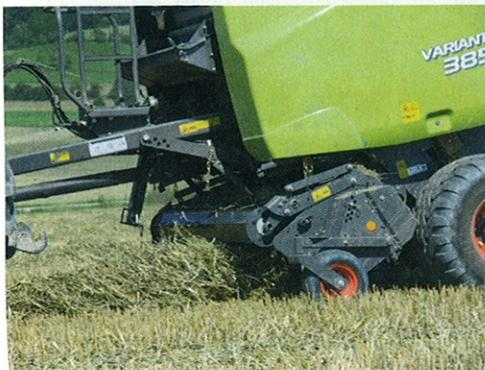
Die gesteuerte Pick-up arbeitet mit vier Zinkenreihen. Die Bodenanpassung erfolgt mittels frei pendelnder Stützräder.
