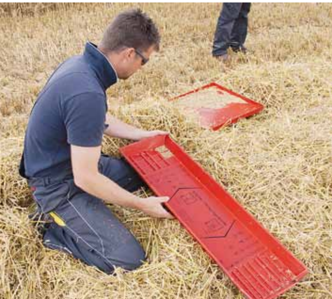
Die Verlustschale war während unserer Messfahrten ständiger Begleiter. 1 % Verlust war das Ziel.
