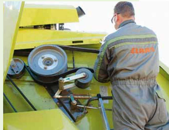
Leider lassen sich die verschiedenen Rotordrehzahlen nicht aus der Kabine verstellen.
