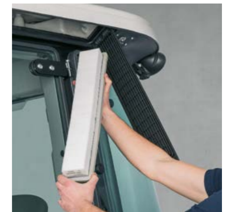
Der Kabinenluftfilter ist zum Reinigen von außen leicht erreichbar und sorgt jederzeit für frisches Klima in der Kabine.
