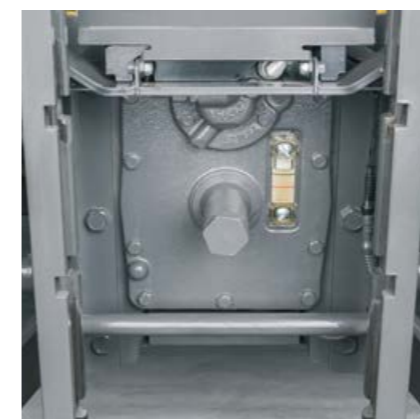
Den Ölstand von Getriebe und Hydraulik kontrollieren Sie über ein Schauglas neben dem Heckzapfwellenstummel.
