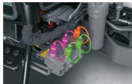
Vorne sind bis zu vier hydraulische Anschlüsse sowie ein freier Rücklauf verfügbar.
