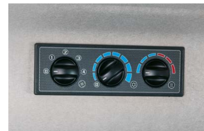
Die Bedienung der Lüftungsanlage ist gut erreichbar auf der rechten Seite im Dachhimmel.
